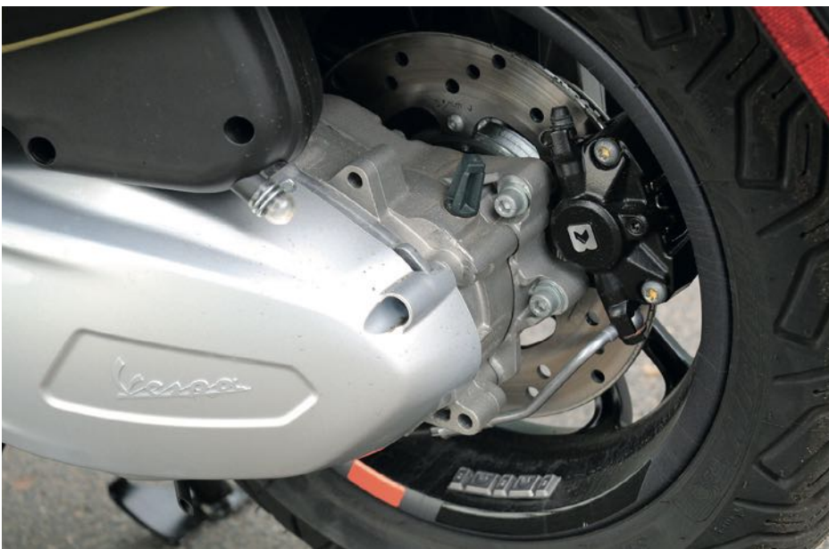
GTS300: Die Kurzschwinge ist das Markenzeichen der Vespa. Das Cockpit informiert analog und digital. Auf die hintere Bremsscheibe wirkt eine Traktionskontrolle. Bei den Blinkern sind LEDs im Einsatz.
