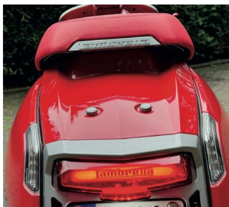
Verschraubungen für einen Gepäckträger sind schon vorhanden, Haltegriffe sind in die Sitzbank integriert.
