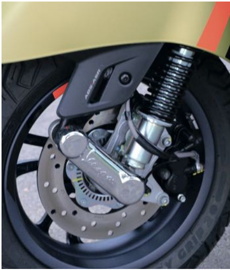
GTS300: Die Kurzschwinge ist das Markenzeichen der Vespa. Das Cockpit informiert analog und digital. Auf die hintere Bremsscheibe wirkt eine Traktionskontrolle. Bei den Blinkern sind LEDs im Einsatz.
