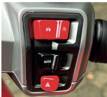
Die rechten Armaturen begnügen sich mit Zünd-Kill-Schalter, Modusknopf und Warnblinker.
