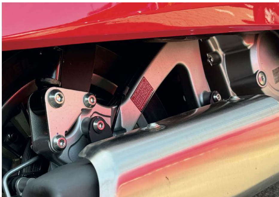
G-Special 350: Der verschraubte Dreiecksarm hinten bringt viel Stabilität. Die Lambretta setzt auf zwei Kurzschwingen. Cockpit mit hell-dunkel-Effekt. Die Gummimatte ziert das Lambretta-Logo.
