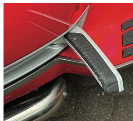
Der Gummiüberzug an den ausklappbaren Soziusrasten sorgt für einen guten Halt auch bei Nässe.
